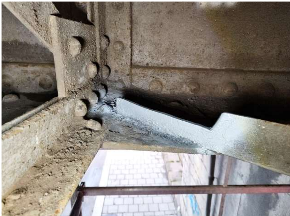
Obr. 60 Odběr oceli na brzdém ztužidle konstrukce K03 – U3
