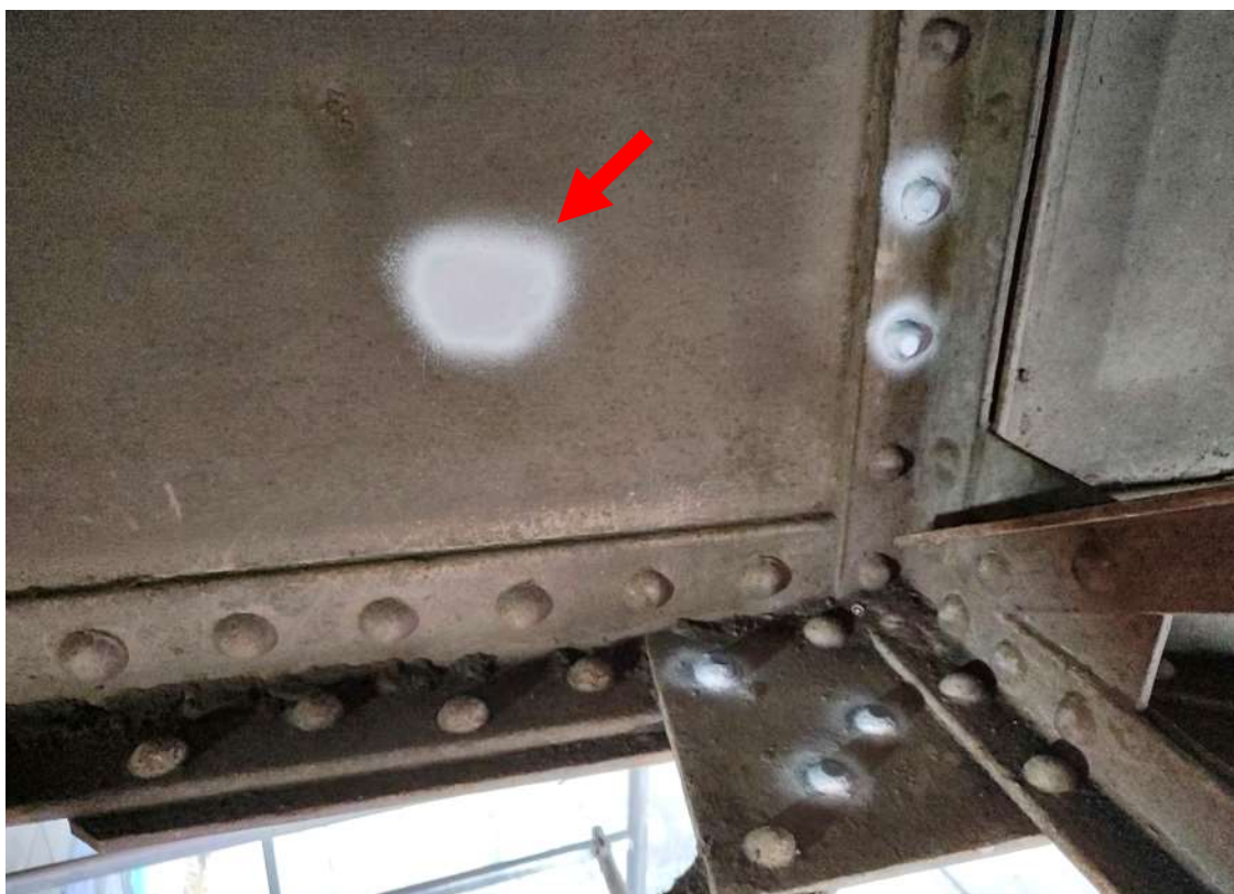
Obr. 52 Tvrdoměrná zkouška ZT9
