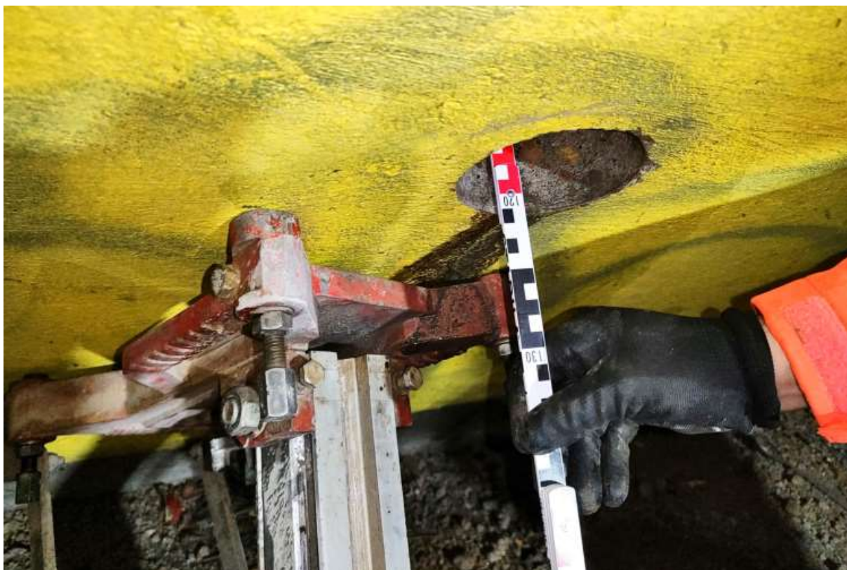
Obrázek 20 Tloušťka klenby v patě činí 120 cm
