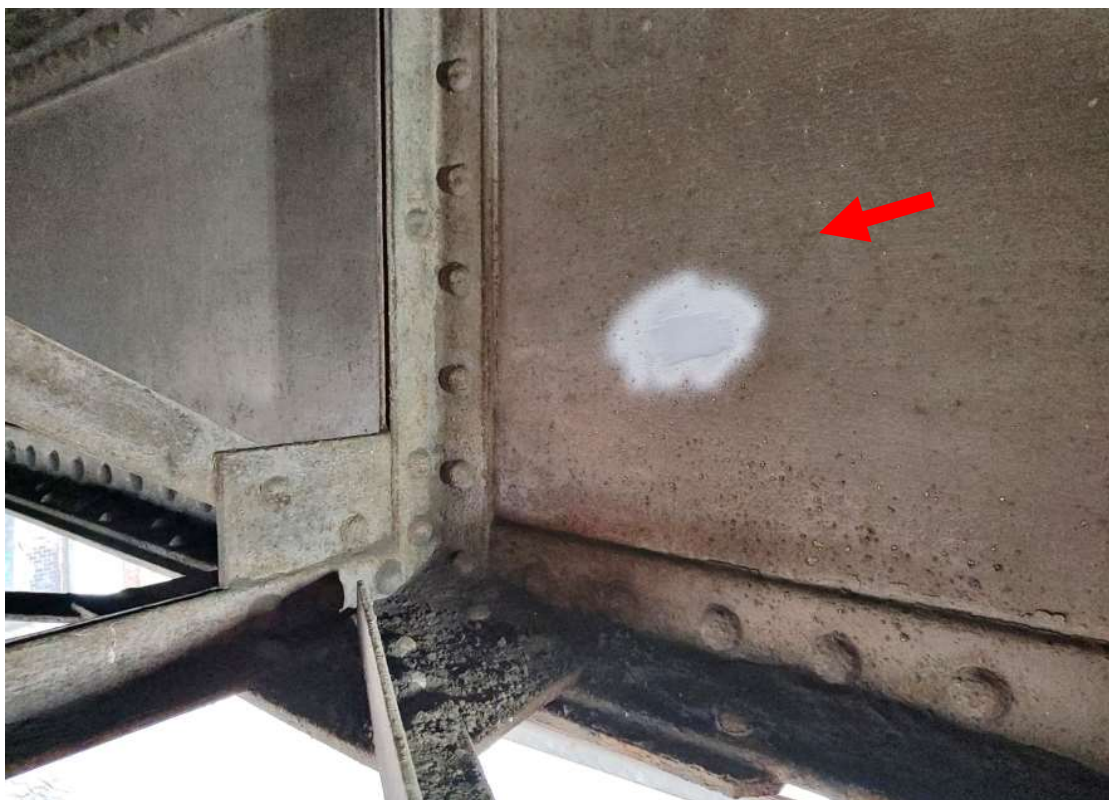
Obr. 50 Tvrdoměrná zkouška ZT6
