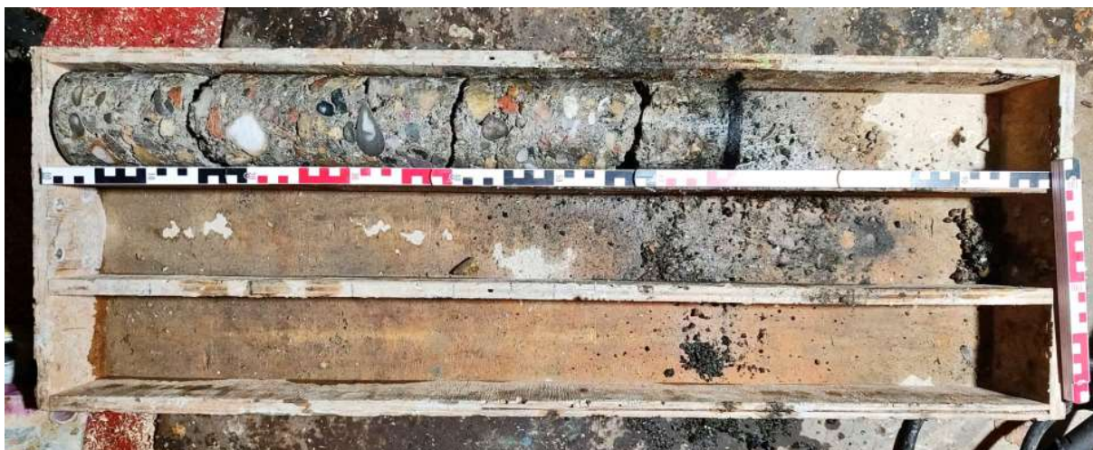
Obrázek 12 Jádrový vývrt JV1 umístěn v 1/4 klenby délky 70 cm
