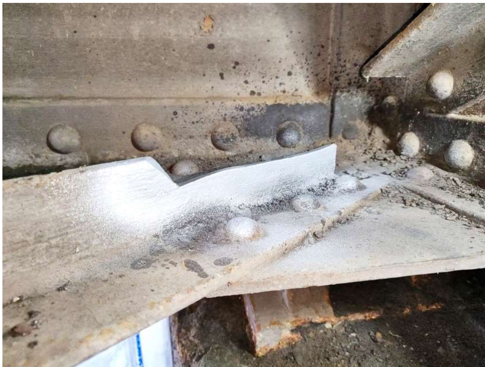
Obr. 56 Odběr oceli na brzdém ztužidle konstrukce K01 – U1
