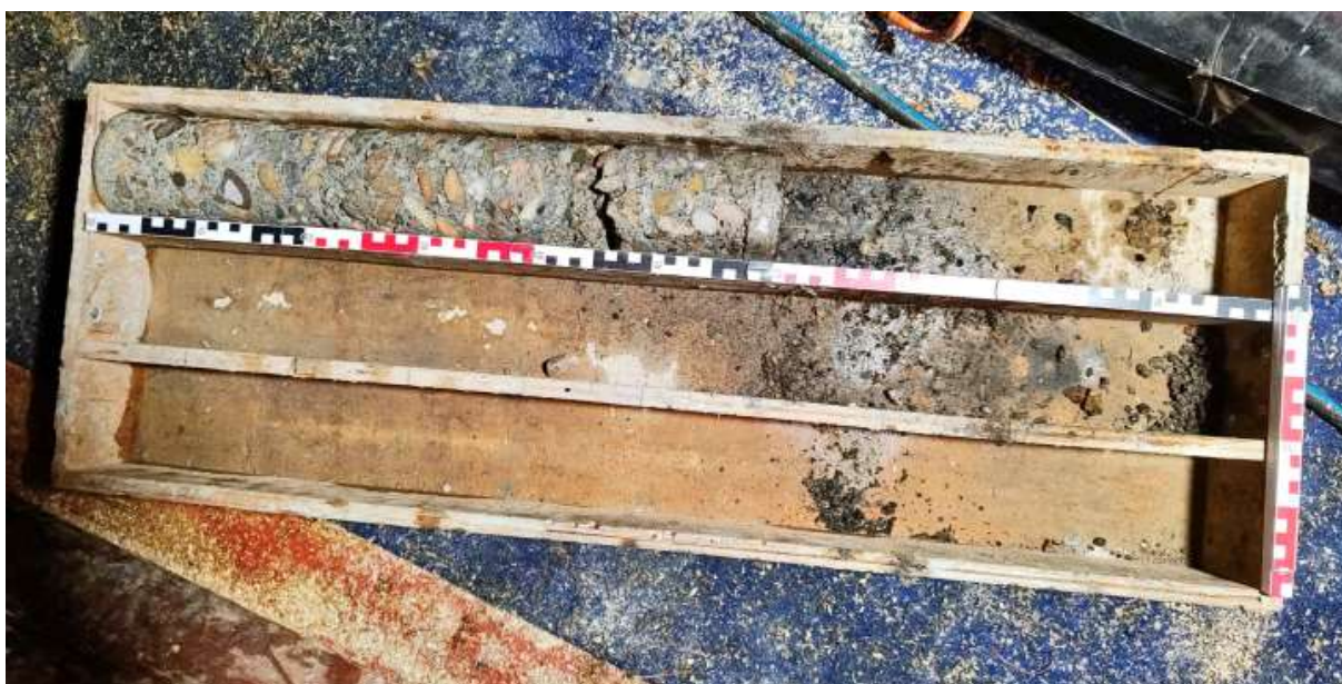
Obrázek 15 Jádrový vývrt JV2 umístěný ve vrcholu klenby délky 60 cm
