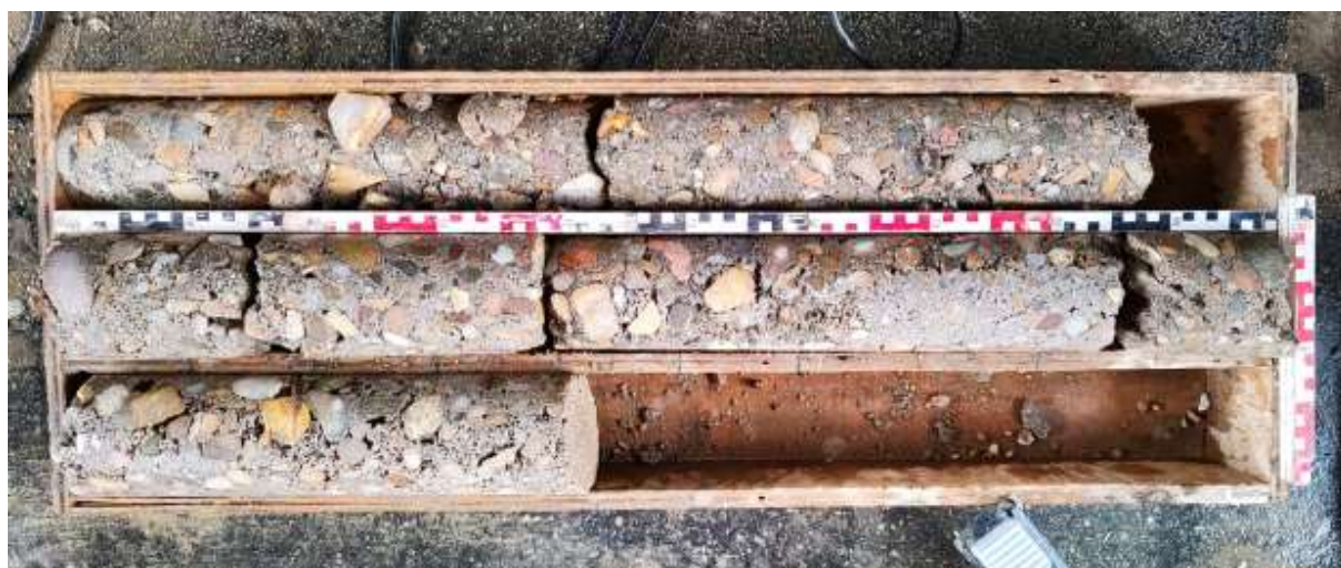
Obrázek 8 Jádrový vývrt JV5 v opěře O2 délky 240 cm
