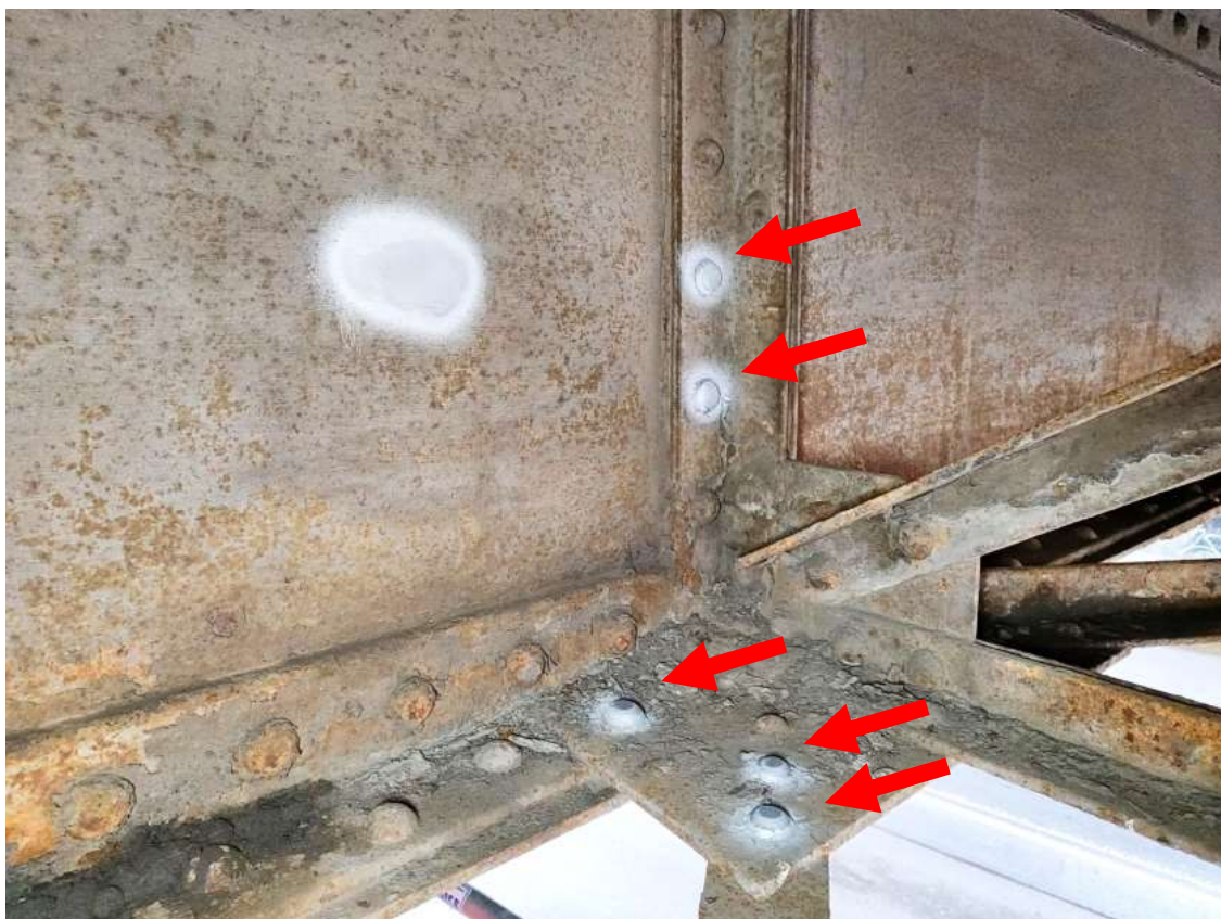
Obr. 49 Tvrdoměrná zkouška ZT1, ZT2, ZT3, ZT4, ZT5
