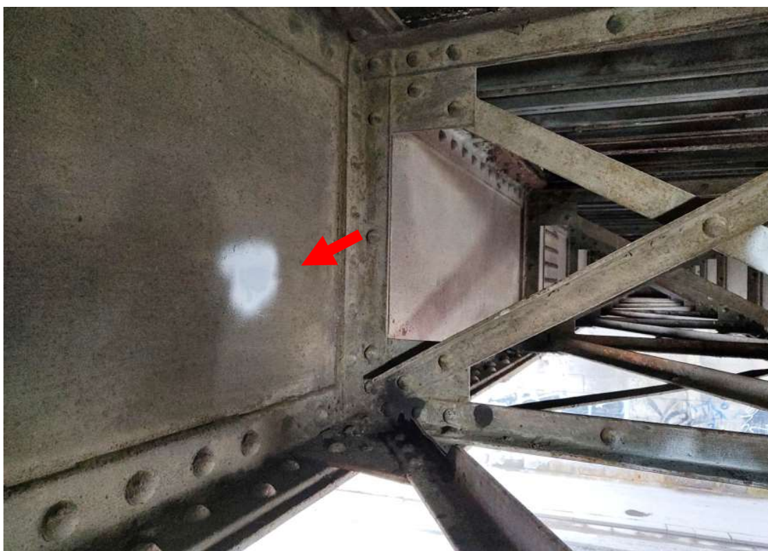
Obr. 52 Tvrdoměrná zkouška ZT9
