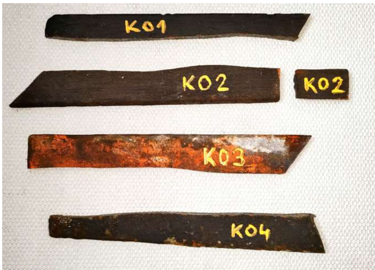
Obrázek 23 Odebrané vzorky oceli z konstrukcí K01 – K04 pro tahové zkoušky a chemickou analýzu
