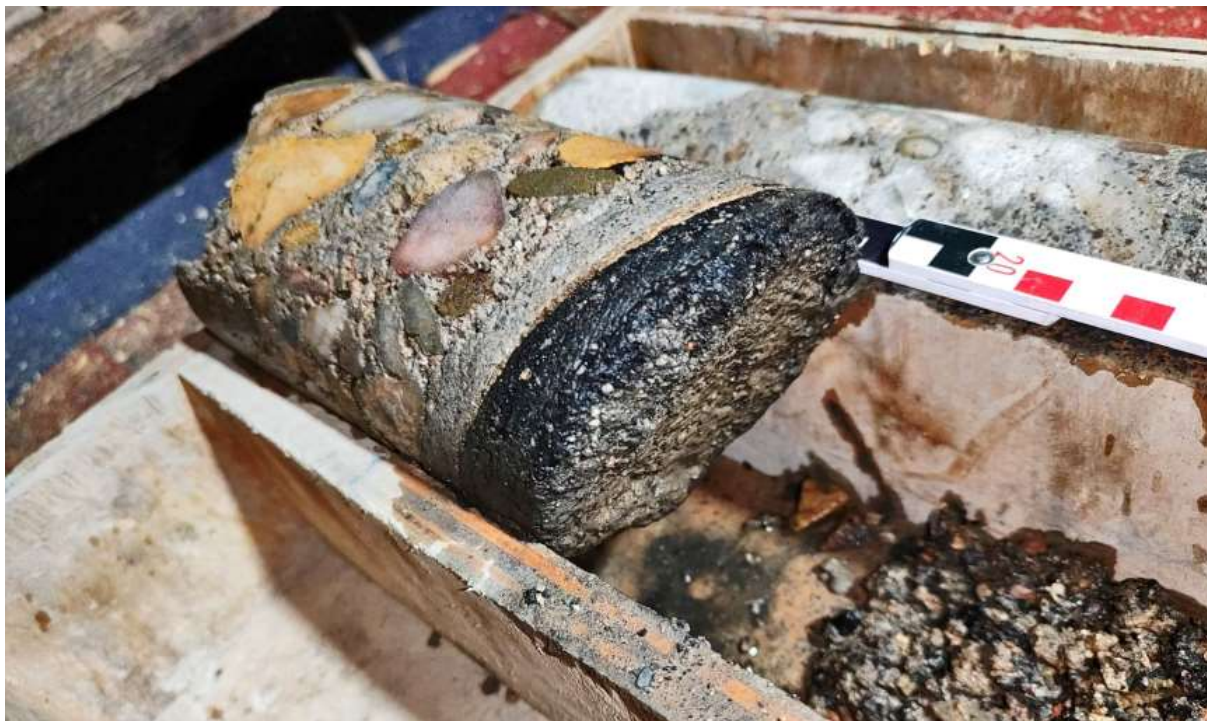
Obrázek 21 Konec jádrového vývrtu JV3
