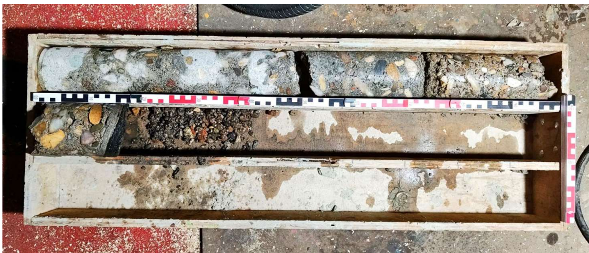
Obrázek 19 Jádrový vývrt JV3 umístěný v patě klenby délky 120 cm
