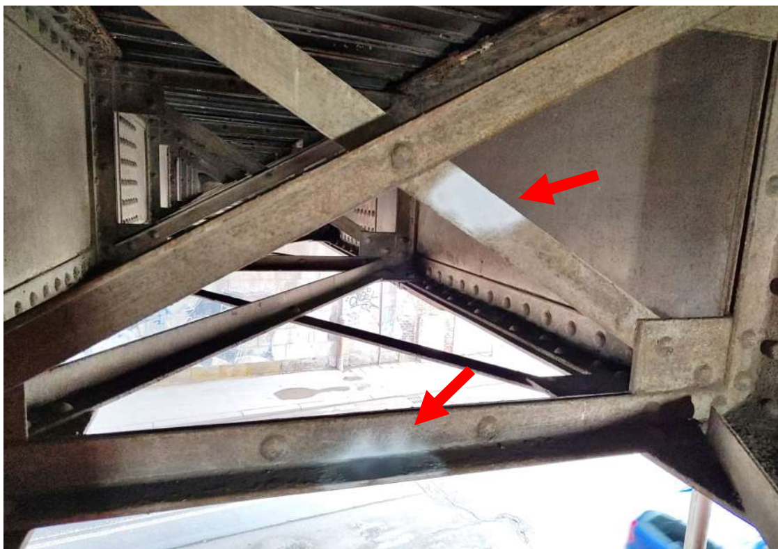
Obr. 51 Tvrdoměrná zkouška ZT7, ZT8
