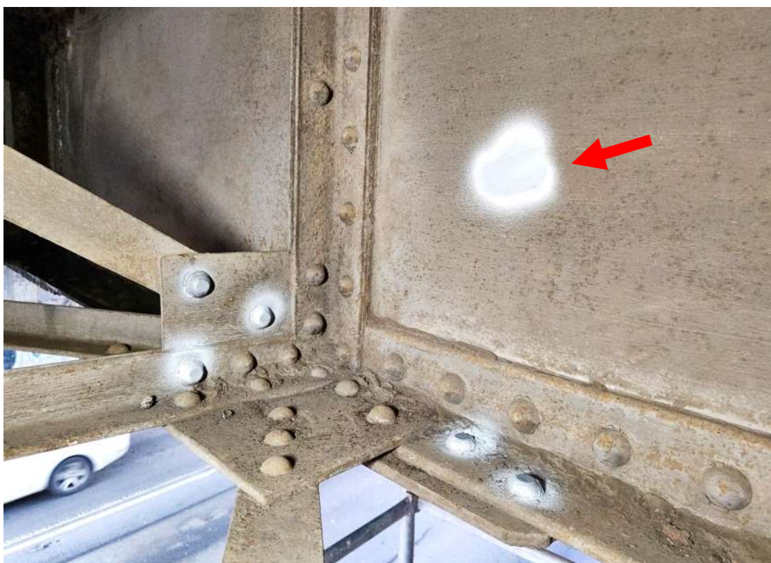
Obr. 50 Tvrdoměrná zkouška ZT6
