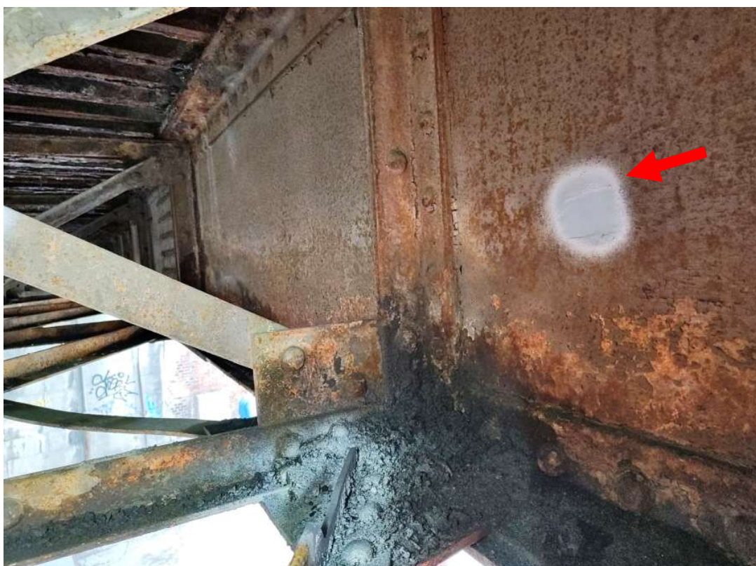
Obr. 50 Tvrdoměrná zkouška ZT6
