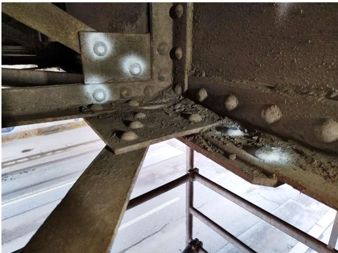
Obr. 49 Tvrdoměrná zkouška ZT1, ZT2, ZT3, ZT4, ZT5
