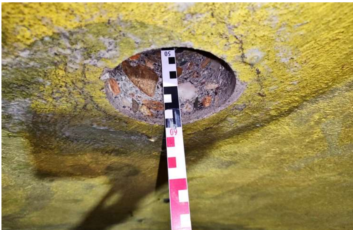
Obrázek 16 Tloušťka klenby ve vrcholu činí 60 cm
