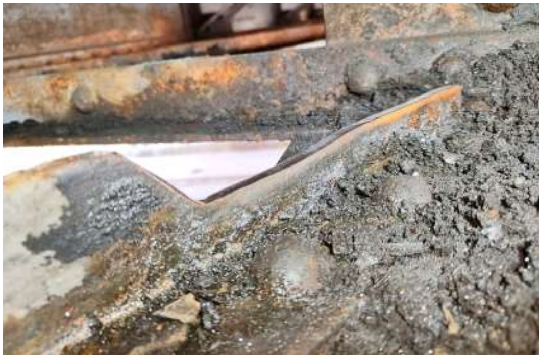
Obr. 61 Odběr oceli na brzdém ztužidle konstrukce K04 – U4
