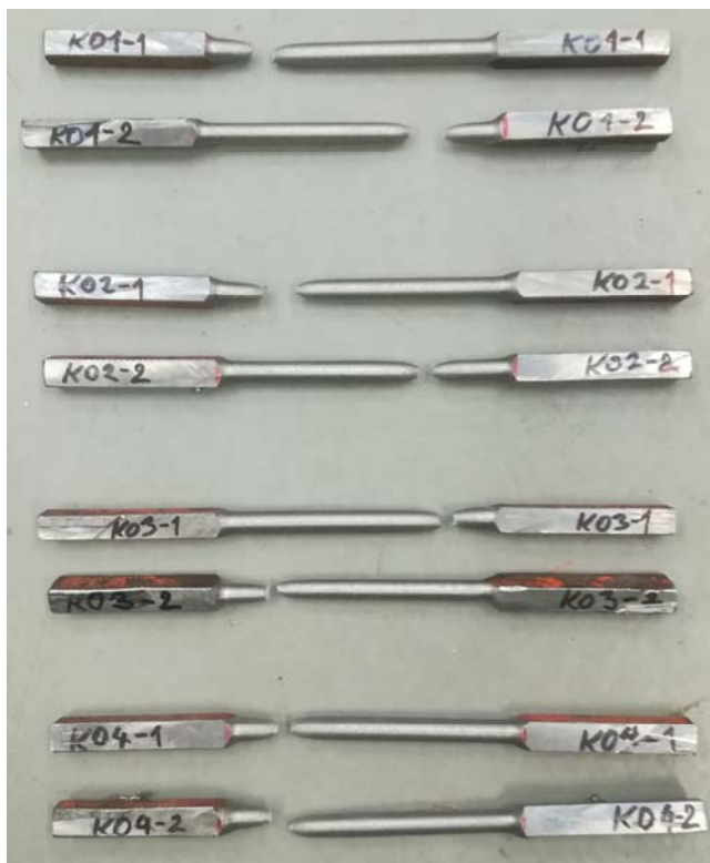
Zkušební tělesa po zkoušce
