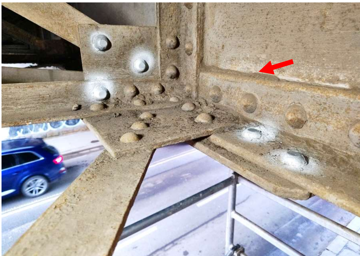
Obr. 49 Tvrdoměrná zkouška ZT1, ZT2, ZT3, ZT4, ZT5
