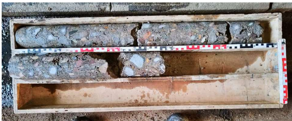
Obrázek 4 Jádrový vývrt JV4 v opěře O1 délky 145 cm
