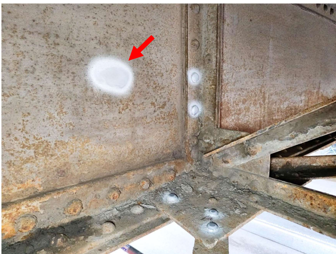
Obr. 52 Tvrdoměrná zkouška ZT9
