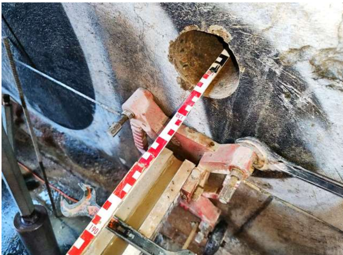
Obrázek 5 Tloušťka mostní opěry O1 je 145 cm
